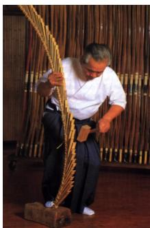
Le Japon n'a ni bétail ni bovidé sauvage et par conséquent ne dispose pas de corne ni de tendon pour fabriquer des arcs composites. En revanche, il possède une très grande quantité d'excellent bambou. Le bambou est très mou et permet un retour rapide après flexion. Il est nerveux, souple et difficilement cassable.
